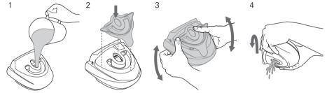
Lave la cámara de agua, el protector antiderrame, la placa de cubeta y la junta de la placa de cubeta en agua tibia, usando un detergente suave. Utilice el tapón de limpieza amarillo como ayuda en el proceso de limpieza (consulte los pasos 1 a 4). Enjuáguelas cuidadosamente en agua limpia y déjelas secar sin exponerlas a la luz directa del sol.
